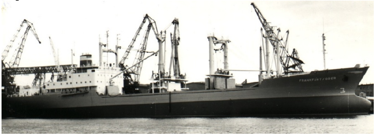
Baugleiches Schiff, Typ Meridian II, Semicontainer, ca. 13600 TDW, Länge ca. 156 m
